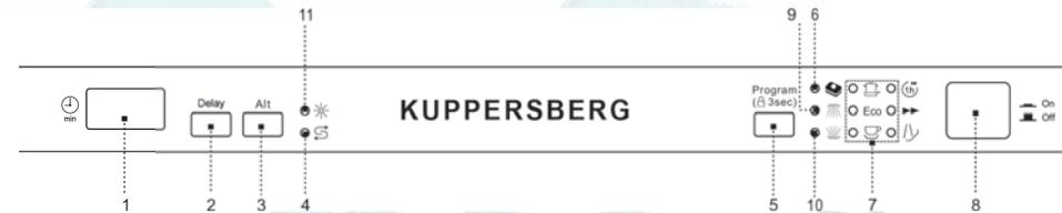
1. Цифровой дисплей: отображает время, оставшееся до окончания рабочего цикла, коды неисправностей и время отсрочки пуска.
